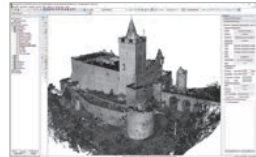
Bad Kösen, Rudelsburg. Ansicht verschmolzene Punktwolke, formgetreue Bauaufnahme mit 3D-Laserscan. fokus GmbH Leipzig (2021)
