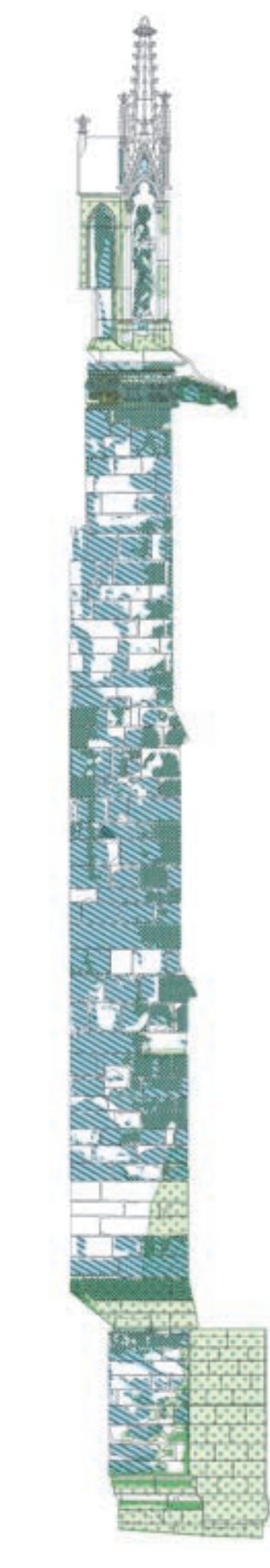
Kölner Dom, Ostseite des Pfeilers F14.2 am Kapellenkranz des mittelalterlichen Chorbaus. Kartierung der Anlagerungsphänomene und des biogenen Bewuchses auf Plangrundlage. © Kölner Dombauhütte, Steinrestaurierungswerkstatt (2022) Plangrundlage: GBVD mbH
